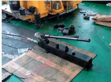
Ручные гидронасосы серии Р разработаны для цилиндров и гидравлических натяжителей болтов. Имеют два диапазона давления (70 Мпа и 160 МПа). Можно выбрать любой размер масляного бака для различного оборудования.
