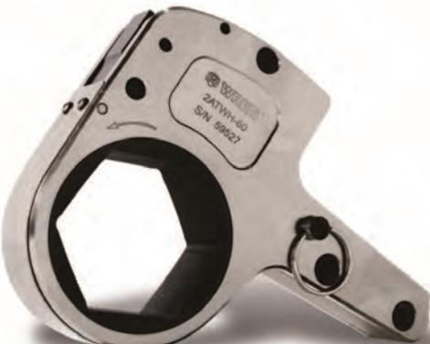
Привод каждой модели ATWH охватывает полный набор шестигранных кассет, все размеры болтов в пределах своего диапазона крутящего момента. При выборе правильной шестигранной кассеты убедитесь, что расстояние между болтом и ограничивающими деталями оборудования больше, чем расстояние «A». Обратите внимание, что между болтами должно быть достаточно места. Вам будут полезны значения «A» и «R» из приведённой ниже таблицы.
